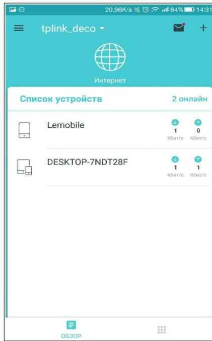
Для добавления дополнительного устройства устанавливаем его на некотором расстоянии (к примеру, в другой комнате) и включаем питание. На главном экране нажимаем «+» и выбираем модель устройства:
